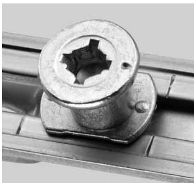
Goujon de sécurité P à tête champignon avec pression de fermeture réglable
